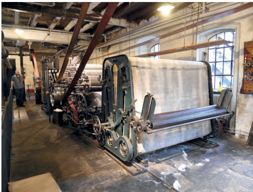
Specifické hodnotící kategorie – hodnota autenticity, autenticita posledního pracovního dne Euskirchen (Německo), LVR-Industriemuseum – Tuchfabrik Müller. Mykací stroj.
