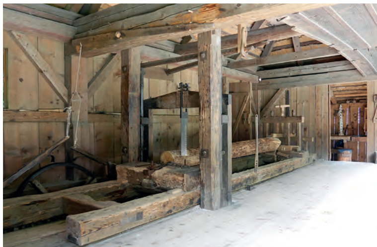
Zachování průmyslového dědictví – transfer Rožnov pod Radhoštěm, Valašské muzeum v přírodě Pila a kladivová valcha přenesené z Velkých Karlovic (nahore a uprostřed) a chvostový buchar hamru pracující původně v Nemílkově. Foto Michaela Ryšková, 2018.
